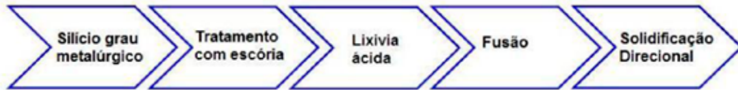
Fig. 5.13 Processo de obtenção de silício de grau solar através de rota metalúrgica desenvolvida pela Elkem Solar . (Fonte: RIMA Industrial)
