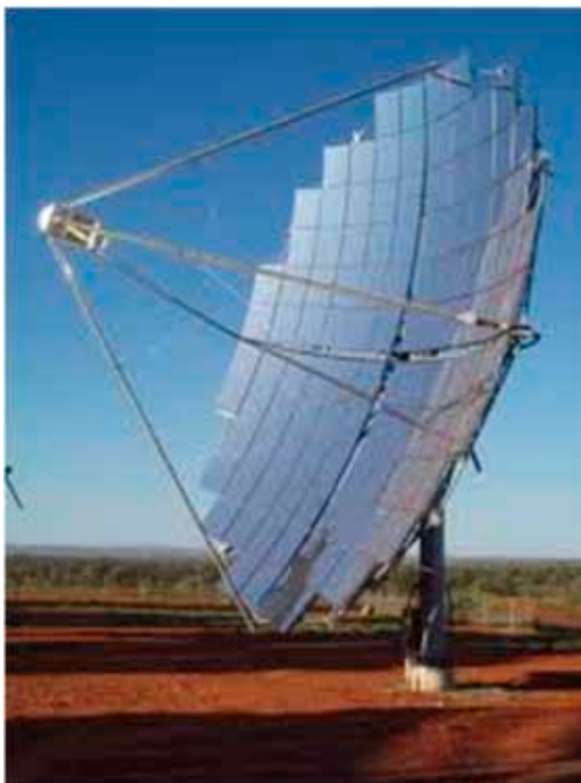
Fig. 7.6 Sistema concentrado fotovoltaico (CPV) utilizando espelhos parabólicos.
