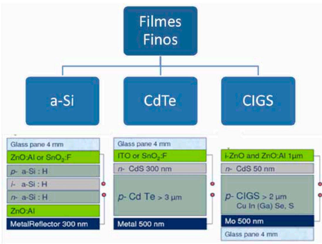
Fig. 5.18 Estrutura da célula de filme fino. (Fonte: Solar&Energy.)
