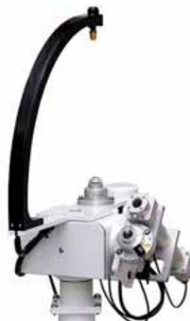
Fig. 7.10 – Piranômetro (esquerda) e pireliômetro (direita). Abaixo rastreador utilizando os dois equipamentos. A haste escura mantém o piranômetro sombreado de forma a medir somente a radiação difusa. A radiação total neste arranjo é obtida somando-se a medição dos dois equipamentos.
