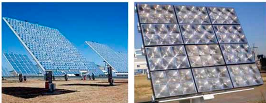
Fig. 7.7 Sistema concentrado fotovoltaico (CPV) com emprego de lentes de Fresnel.
