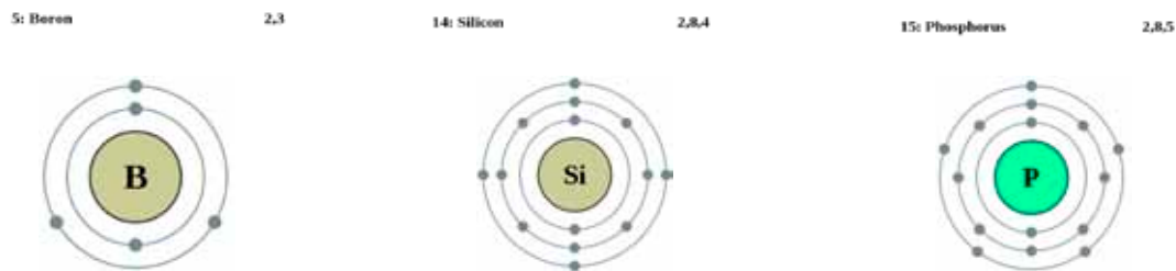
Fig. 7.2 – Célula de boro (esq.), silício (centro) e fósforo (dir.) com número de elétrons na banda de valência, respectivamente igual a 3,4, e 5. Isto explica porque o boro é utilizado como dopante para formar o semiconductor tipo-p e o fósforo para formar o semiconductor tipo-n de uma célula de silício.
