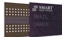
quisitos do PPB, passou a oferecer também para os segmentos de TV, Set Top Box, PC e Tablet, componentes de memória na tecnologia DDR3 na organização de barramento x16. O novo componente está disponível na densidade de 4 Gb. O produto utiliza processo de produção inovador, sendo encapsulado no Brasil com a mais moderna tecnologia de semicondutores.
