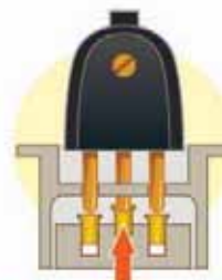
Pino de Aterramento
